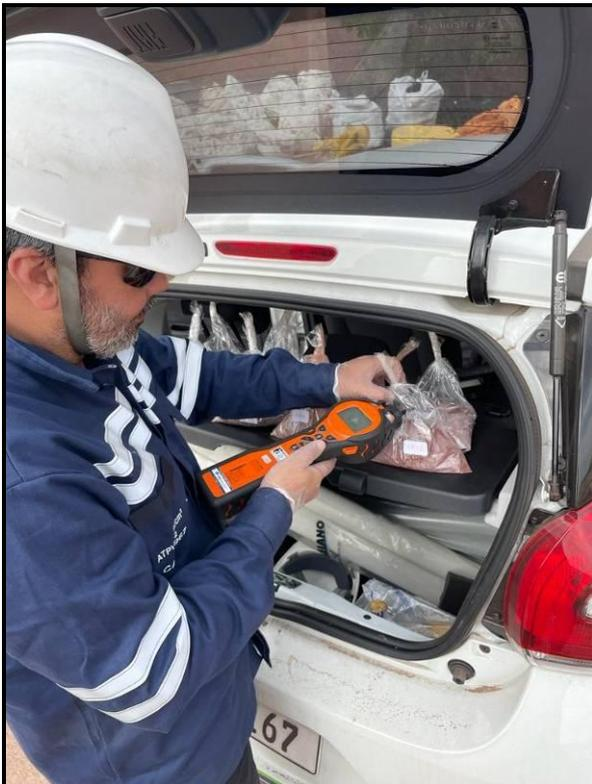
Foto 3: Medição de volátil em amostras de solo.
